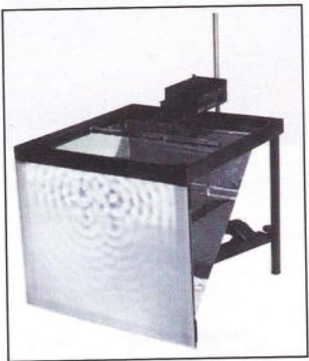
Fig. 23 Dispozitiv pentru punerea în evidență a fronturilor de undă
