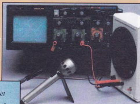
Construcția microfonului electrodinamic are la bază fenomenul de inducție electromagnetică
