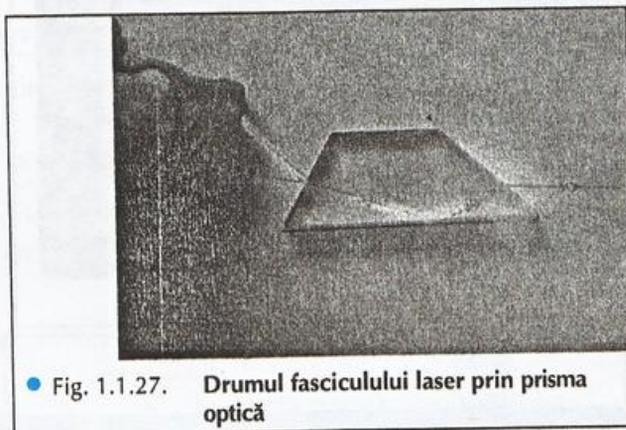
● Fig. 1.1.27. Drumul fasciculului laser prin prisma optică
