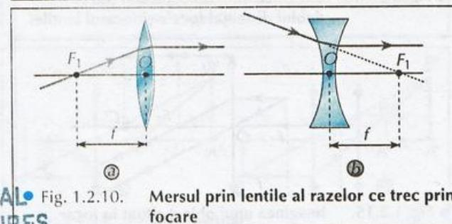
● Fig. 1.2.10. Mersul prin lentile al razelor ce trec prin focare
