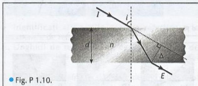
**Problema 1.10.** Un mediu transparent cuprins între două suprafețe plane și paralele formează o lamă cu fețe plan-paralele. Se consideră o astfel de lamă, de grosime  $d$  și indice de refracție  $n$ , plasată într-un alt mediu transparent (fig. P 1.10). Folosind legile refracției și considerente geometrice demonstrați că: a) raza emergentă  $E$  este paralelă cu raza incidentă  $I$ ; b) distanța,  $\Delta$ , dintre aceste două raze este dată de relația
