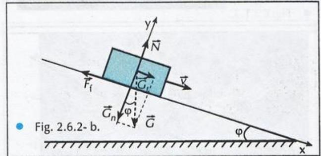
**Exercițiul 2.6.3.** Calculați ce forță orizontală  $F$  acționează asupra unui corp de masă  $m = 1$  kg care urcă uniform pe un plan înclinat de unghi  $\alpha = 30^\circ$ . Unghiul de frecare este  $\varphi = 15^\circ$ .
