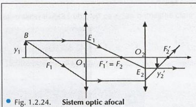
Fig. 1.2.24. Sistem optic afocal
