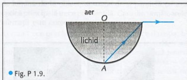
**Problema 1.9.** Un vas având forma unei emisfere, cu centrul în  $O$ , este umplut cu un lichid (fig. P 1.9.). O sursă de lumină aflată în  $A$  emite o rază luminoasă care urmează drumul din figura P 1.9. Aflați indicele de refracție relativ al lichidului față de aer.
