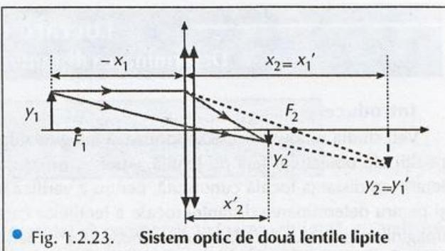
Fig. 1.2.23. Sistem optic de două lentile lipite
