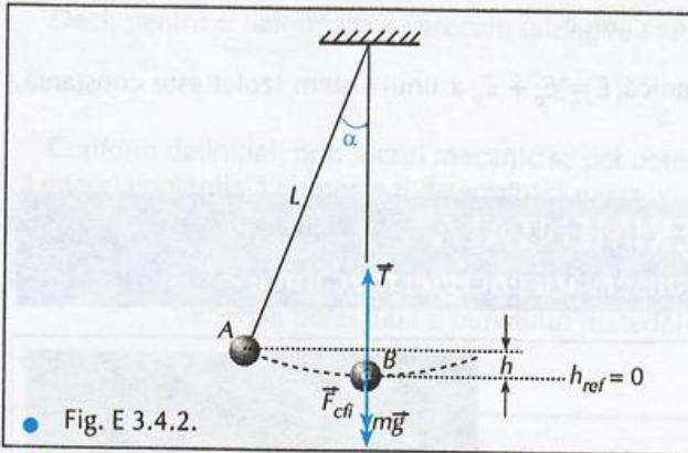
Aplicație:  $L = 60 \text{ cm}$ ;  $m = 400 \text{ g}$ ;  $T = 4 \text{ N}$ .
