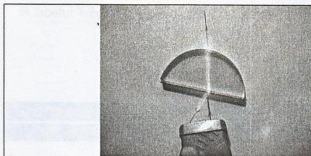
● Fig. 1.1.19. Drumul fasciculului laser prin lentila semicilindrică
