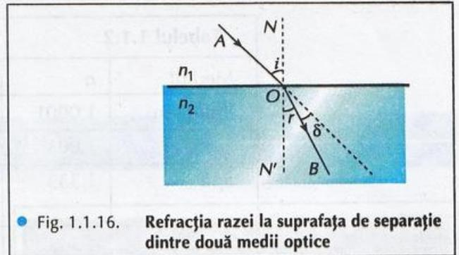
• Fig. 1.1.16. Refracția razei la suprafața de separație dintre două medii optice
