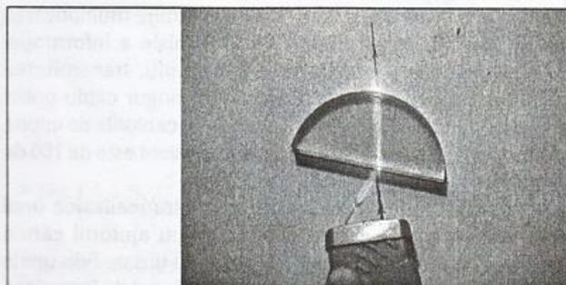
● Fig. 1.1.20. Drumul fasciculului laser prin lama cu fețe plan-paralele
