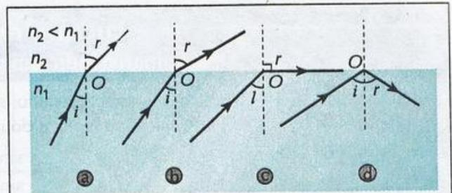
• Fig. 1.1.17. Refracția la diferite unghiuri de incidență
