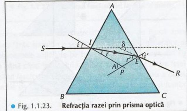
• Fig. 1.1.23. Refracția razei prin prisma optică
