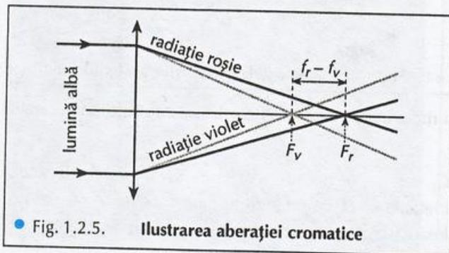
figura 1.2.5. Așa cum se vede (rombul din figură) există atât o aberație cromatică *transversală*, cât și una *orizontală*.
