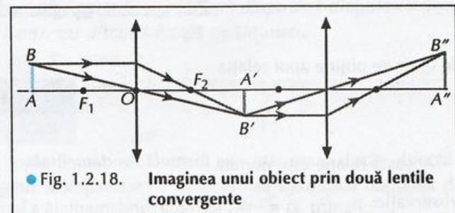
Să considerăm apoi situația din figura 1.2.19. Fie  $A'B'$  imaginea dată de o lentilă convergentă unui obiect real  $AB$  (fig. 1.2.19-a). Dacă între lentilă și imaginea  $A'B'$  se așază o altă lentilă convergentă (fig. 1.2.19-b), raza care trece prin centrul optic al primei lentile este deviată la trecerea prin a doua lentilă, astfel încât imaginea obiectului  $AB$  este  $A''B''$ . În acest caz se spune că *imaginea  $A'B'$  a devenit obiect virtual pentru a doua lentilă.*
